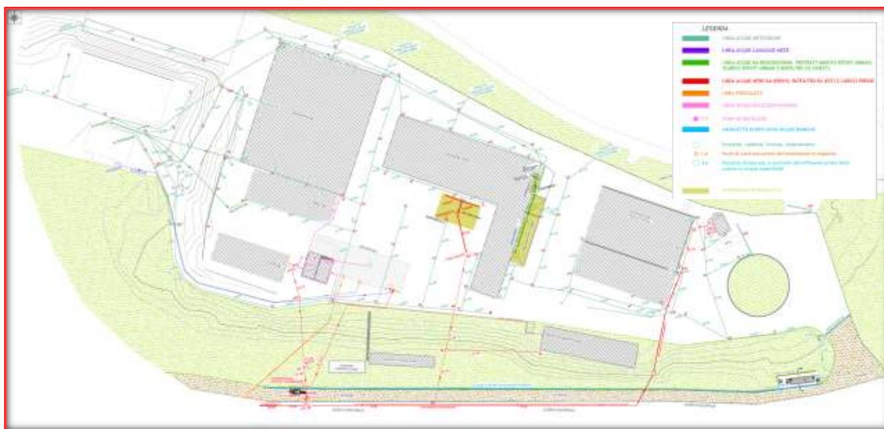
FIGURA 24: PLANIMETRIA - PARTICOLARE DEL PROGETTO REGIMAZIONE DELLA ACQUE METEORICHE
