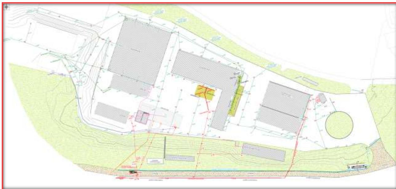
**FIGURA 8: PLANIMETRIA - PARTICOLARE DEL PROGETTO REGIMAZIONE DELLA ACQUE METEORICHE**
